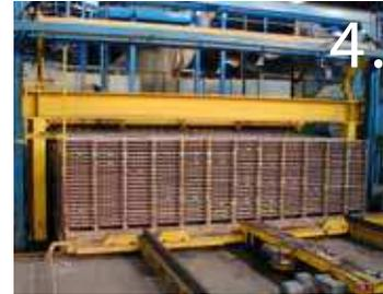
Les produits fraîchement pressés sont empilés sur des wagons puis acheminés jusqu'au four qui se décompose en 2 parties : une partie séchage, une partie cuisson. Le séchage permettra de réduire le taux d'humidité à moins de 1%, il durera 15 à 20 heures pendant lesquelles la température s'élèvera jusqu'à 150° C.
